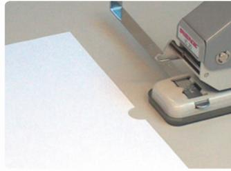
Anschließend kann das Papier, welches nun mit einem Daumenloch von 20 mm Durchmesser versehen ist, entnommen werden.
