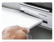
Die APSI 300 compact besitzt eine integrierte Maßskala zur Ermittelung des korrekten Spiralendurchmessers für jede Blockstärke.
