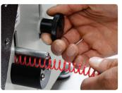
Die APSI 300 compact erfordert für das einfache Setup und die Durchmessereinstellung kein Werkzeug. Die innovative Durchmessereinrichtung der APSI erlaubt ein einfaches und präzises Positionieren der Spiralen.
