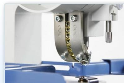
Detailsicht Ösenkanal mit automatischer Zuführung
