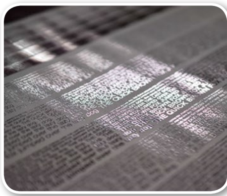
Partielle Digitaldruckveredelung mit Sleekingfolie.
