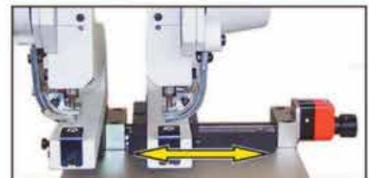
Bild: Verstellbarer Ösabstand mit digitaler Positionsanzeige
