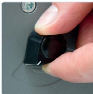
Der Randabstand kann mit Hilfe eines Drehknopfes zwischen 2 mm und 4,5 mm angepasst werden. Somit kann tiefer in das Papier gestanzt werden.
