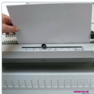
Vertikales Stanzen erhöht die Präzision beim Stanzvorgang.
