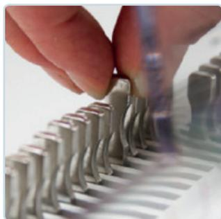
Die QSA-Technologie (Quick Size Adjustment) erlaubt das sekundenschnelle Ausschalten der Stanzstempel, wodurch Papierformate einfach und schnell gewechselt werden können.
