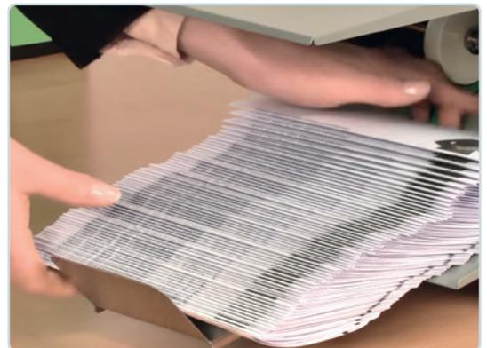
Kontinuierliches Arbeiten, Entnahme auch während der Produktion
