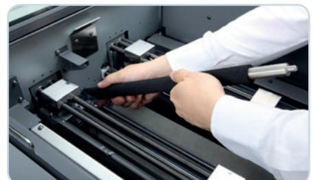
Der AeroCut X hat abnehmbare Rollen, für einfache Wartung und Reinigung.
