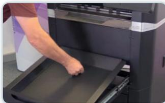
Das **Auffangfach** für produzierte Medien läßt sich bei Nichtgebrauch leicht in das Gerät einschieben.
