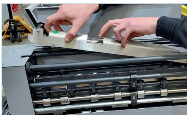
Entfernen der Sicherheitsabdeckung „EasyBlade“.
