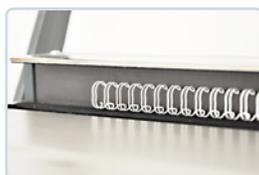
Magnetleiste zur Positionierung der Drahtbinderücken
